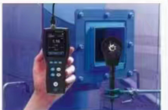
管道出风口测试
